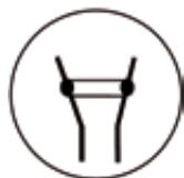
IEC 60947-5-1 Механически связанные контакты
